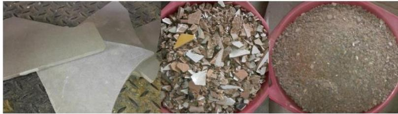
**Figura 2.** Proceso de trituración de baldosa cerámica
