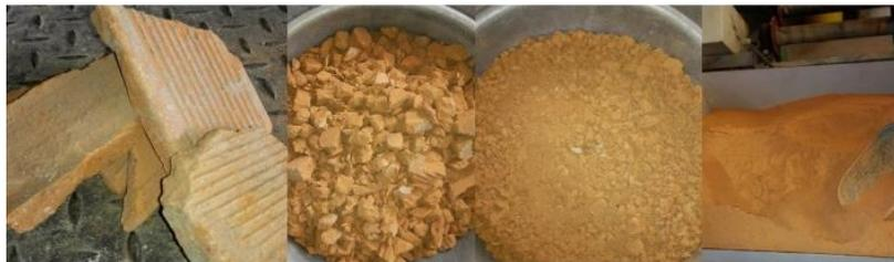
**Figura 3.** Proceso de trituración de ladrillo cerámico
