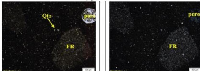
Cemento + Metacaolín: Nicotes paralelos y cruzados. Aspecto general del cemento bajo microscopio petrográfico, puntos blancos de microgramos de cuarzo tamaño limo (Qtz) y fragmentos subangulosos flotantes en el cemento (FR)
