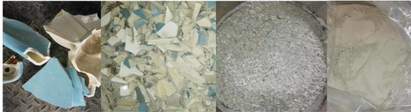
**Figura 1.** Proceso de trituración de aparatos sanitarios
